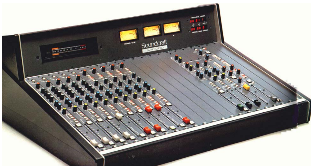
Slika 11.9 - Jedan model emisione miksete na kojoj se vidi koncept postavljanja ulaznih modula s leva na desno, a grupnih i izlaznih modula na krajnjoj desnoj strani.
